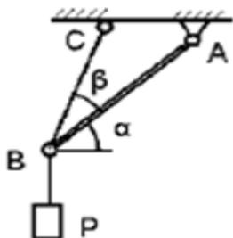
2. Груз весом  $P = 10 \text{ Н}$  подвешен на двух тросах АВ и ВС, составляющих с горизонтальной прямой углы  $\beta = 15^\circ$  и  $\alpha = 30^\circ$ . Определить усилия в тросах.
